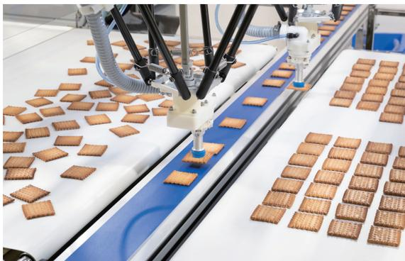
滞留した製品を予備スペースへ逃がし、再稼働後に自動で復帰できる高速ピッキングシステム
